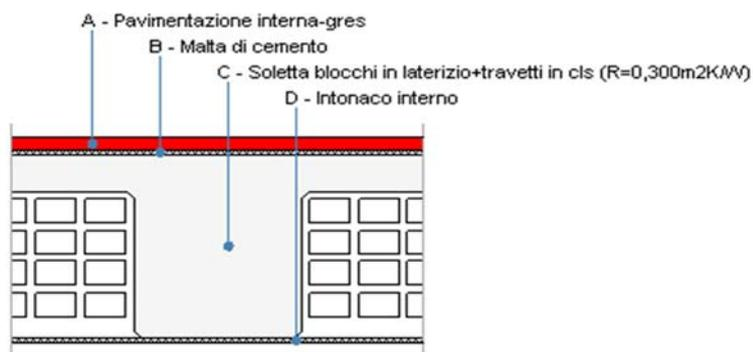
Le proprietà termiche dell'elemento opaco sono valutate in base alla UNI EN ISO 6946.
