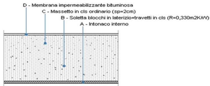
Le proprietà termiche dell'elemento opaco sono valutate in base alla UNI EN ISO 6946.
