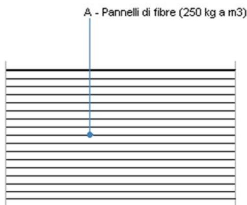
Le proprietà termiche dell'elemento opaco sono valutate in base alla UNI EN ISO 6946.
