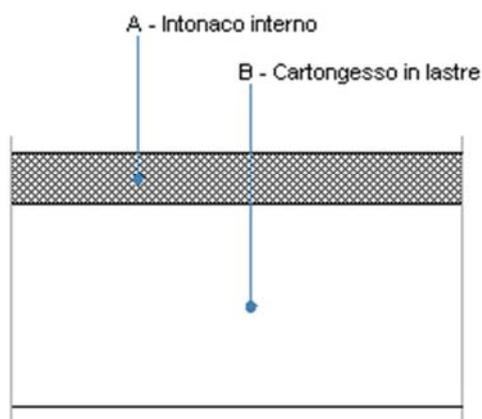
Le proprietà termiche dell'elemento opaco sono valutate in base alla UNI EN ISO 6946.
