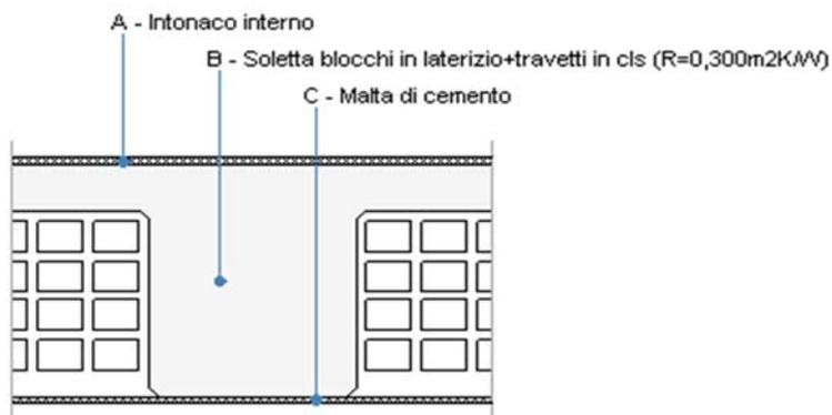
Le proprietà termiche dell'elemento opaco sono valutate in base alla UNI EN ISO 6946.
