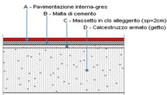
Le proprietà termiche dell'elemento opaco sono valutate in base alla UNI EN ISO 6946.
