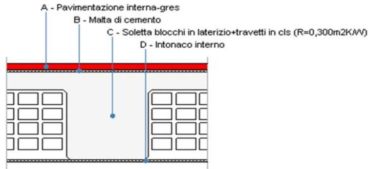
Le proprietà termiche dell'elemento opaco sono valutate in base alla UNI EN ISO 6946.
